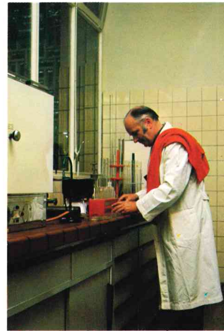
1 = Wasserwerkswärter Schneider kontrolliert täglich mit Filtern den Grad der Verunreinigung des in Nieringsen ankommenden Wassers.
