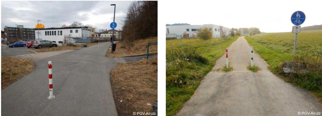
Abb. 5-23: Wiederkehrende Poller auf dem Bahnradweg (links) und mit unzureichender Durchlassbreite im Zuge des Mühlenweges (rechts)
