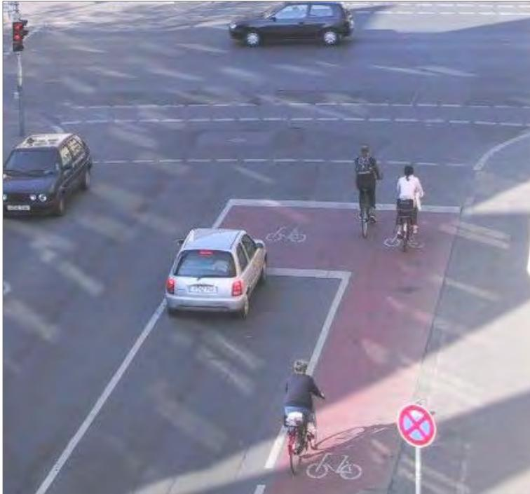
Abb. 5-19: Aufgeweiteter Radaufstellstreifen (ARAS) (Hannover)
